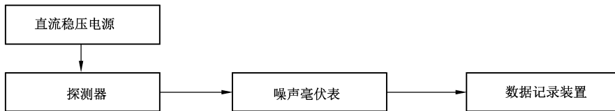
图 14 噪声电压测试原理图
