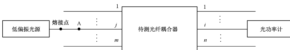
图 8 附加损耗测试装置原理图
