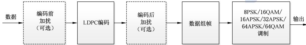
图 E.11 数据操作流程 11
