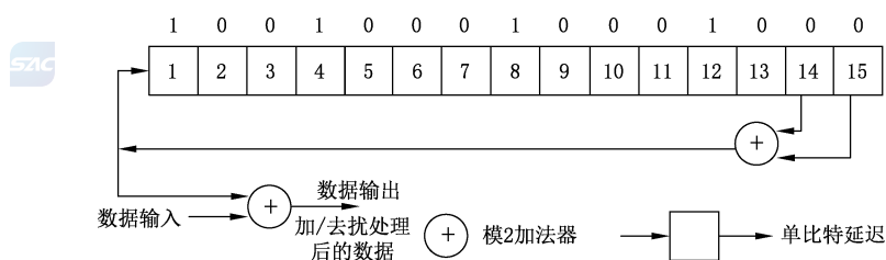
图 C.4 反馈输出结构示意图
