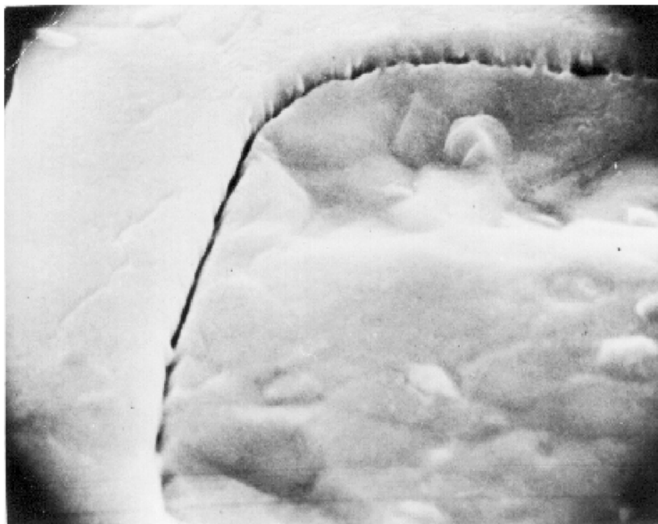
图 11 (7000 倍) 钝化层台阶上的金属间隔(基极接触) (拒收)
