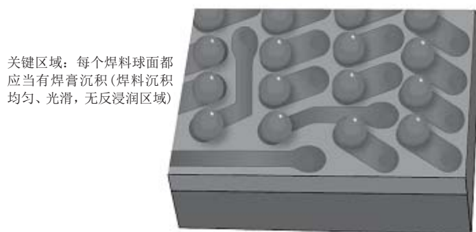
图 A.10 面阵列安装器件
