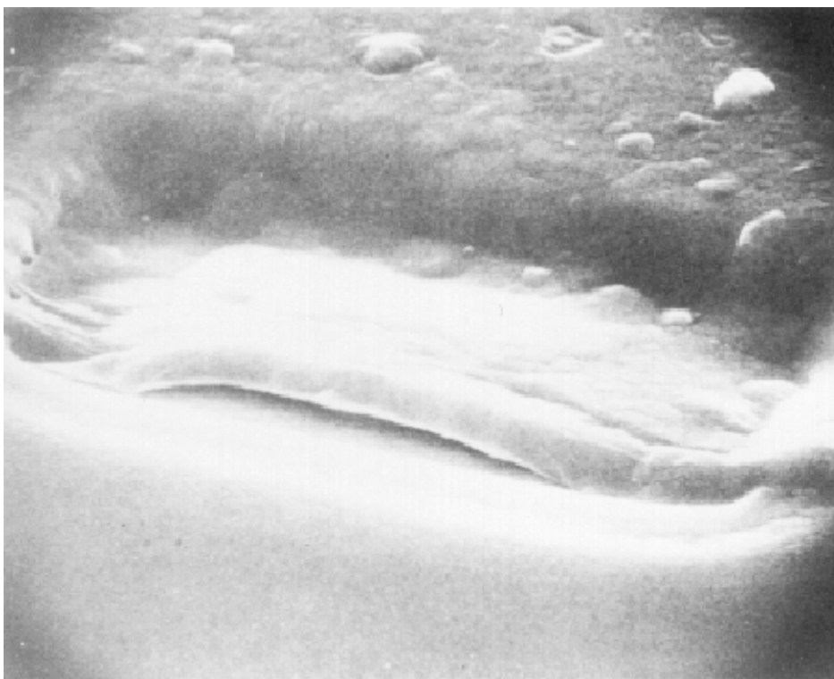
图 18 (5000 倍) 在接触窗口区域一般金属化层的剥皮或浮起 (拒收)
