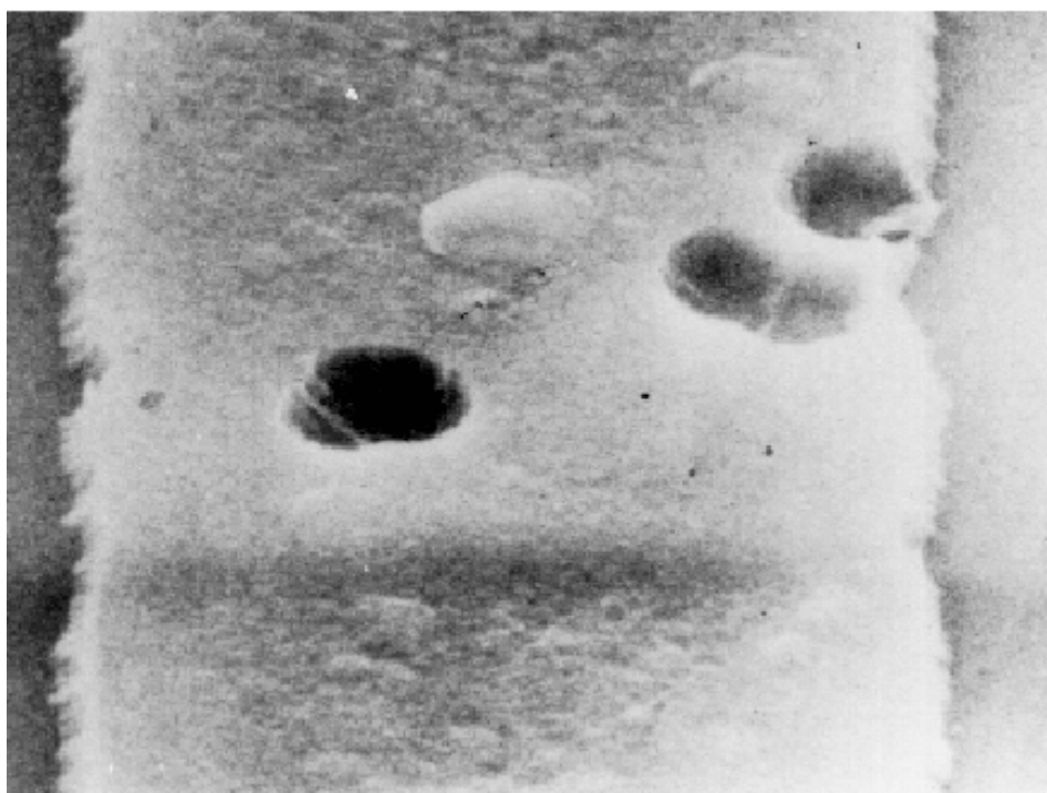
图 20 (5000 倍)一般金属化层中的空洞(拒收)
