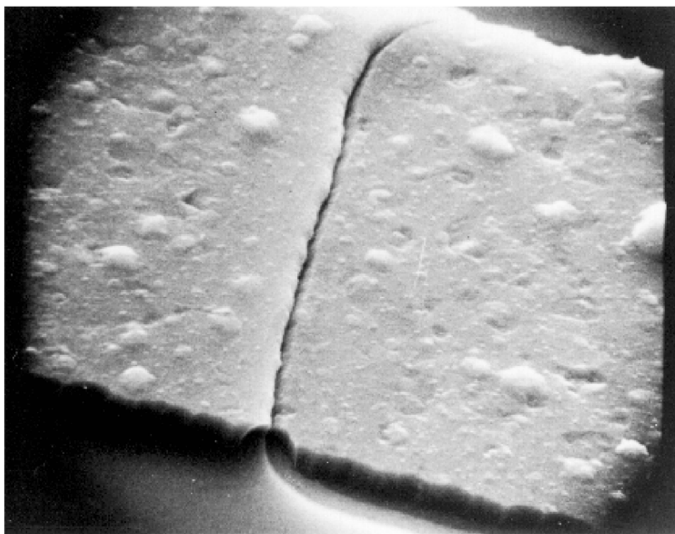
图 9 (5000 倍) 钝化层台阶上的隧道/洞(拒收)
