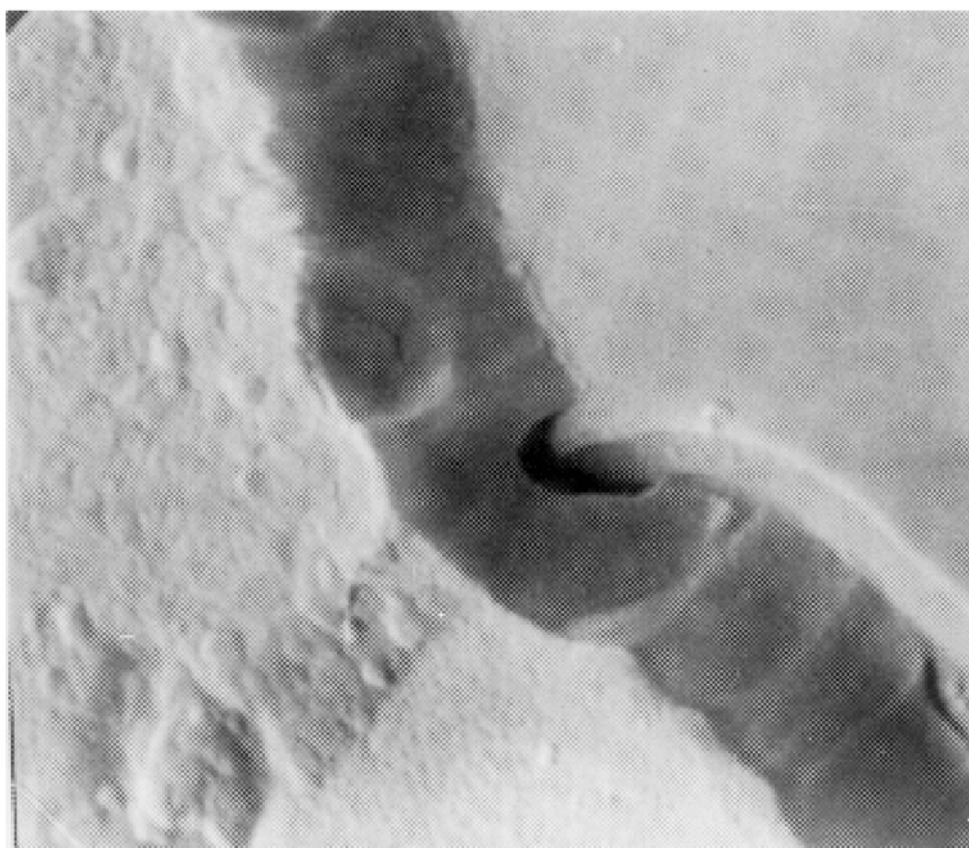
图 7 (5000 倍) 钝化层台阶上的空洞(拒收)
