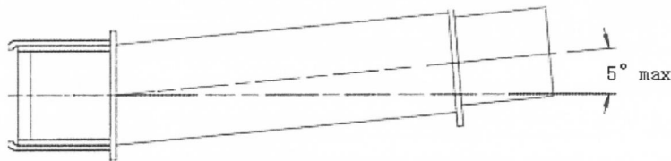
图 1 端帽与电阻器主体的不同心度
