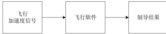
图 1 制导系统飞行软件开路仿真试验原理框图
